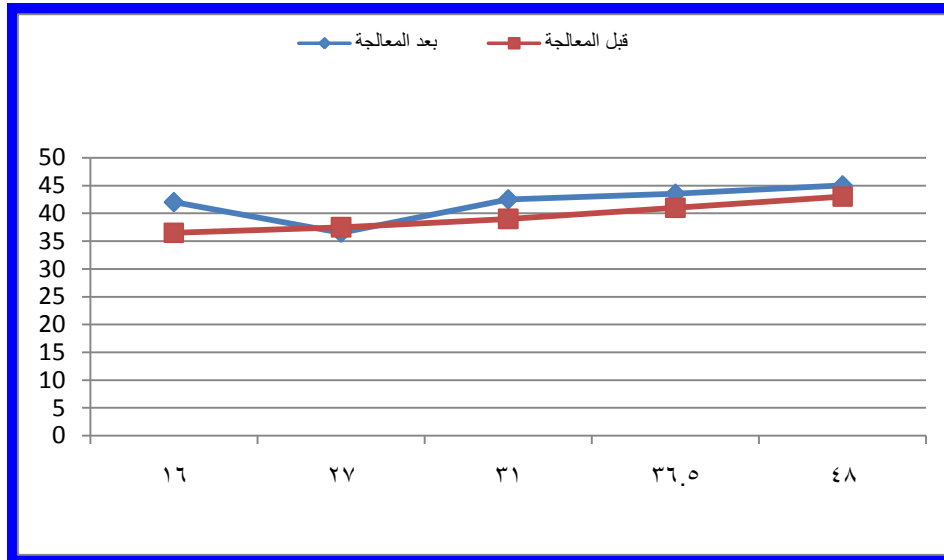
شكل رقم (٥): العلاقة بين وزن المتر المربع و الملمس قبل وبعد المعالجة للأقمشة غير المنسوجة لعينات البولي بروبلين
