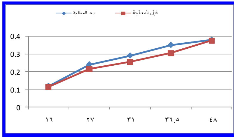
شكل رقم (٧): العلاقة بين وزن المتر المربع و السمك قبل وبعد المعالجة للأقمشة غير المنسوجة لعينات البولي بروبلين
