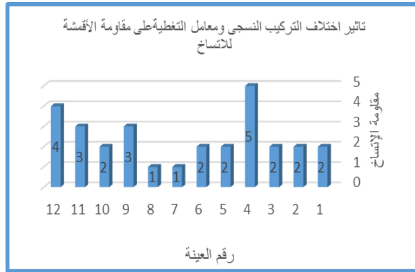
شكل (٣) تأثير اختلاف التركيب النسجي ومعامل التغطية على مقاومة الاتساخ للأقمشة
