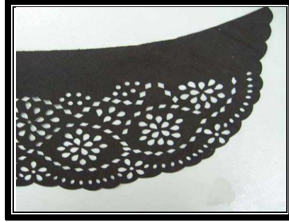
صورة (2) تفريغ القماش باستخدام الليزر (20)
