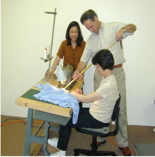
صورة (٣) توضح تعديل طاولة الحياكة تبعاً لطول العامل
