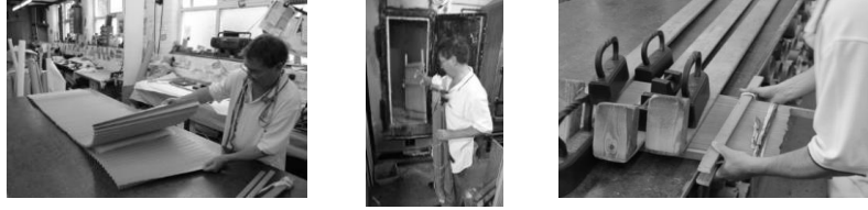
صورة (٤) لضم العامل الهيكل الكرتونى لتشكيل الكسرات وربطها بإحكام ووضع العامل للقالب فى الفرن http://www.cimentpleating.com/about
