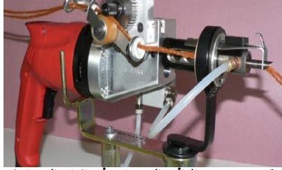
صورة (1) مسدس التافت المستخدم في إنتاج السجاد نصف الآلي- نقلاً عن
