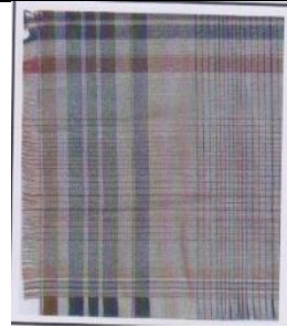
شكل (7) صورة العينة رقم (7) التركيب النسجي سادة 1/1 نمرة السداء 2/40 انجليزي نمرة اللحمة 150 دنير
