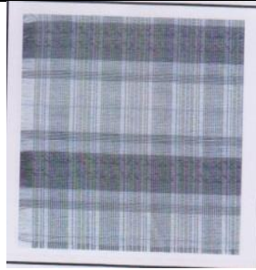
شكل (9) صورة العينة رقم (9) التركيب النسجي سادة 1/1 نمرة السداء 2/40 انجليزي نمرة اللحمة 150 دنير
